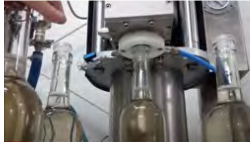
Tıpalama makinasının yardımı manuel kapama www.youtube.com/watch?v=UiuEXjB0EIk
